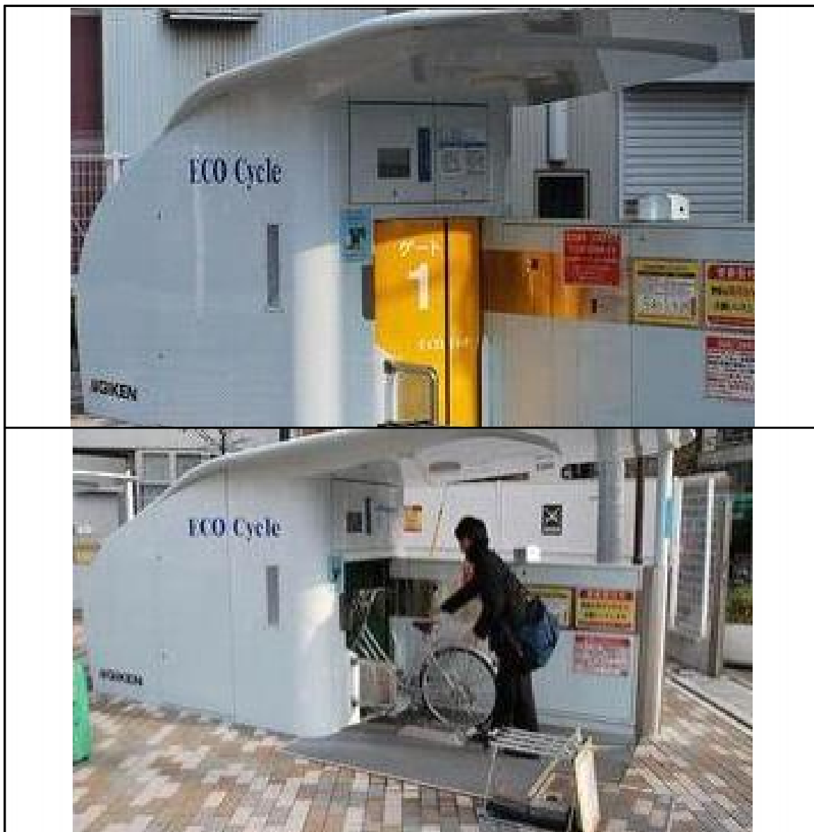
【기계식 주차장(Eco Cycle)】
